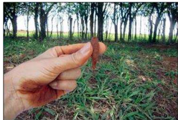
Foto 6 – Avaliação de plasticidade e teste de resistência de cilindro
